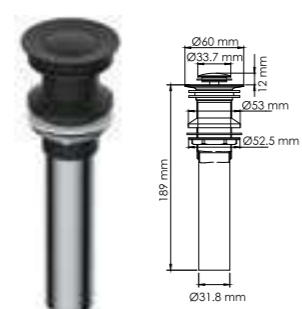
A250 Донный клапан Push-up для раковин без перелива Покрытие черный Soft-touch.
