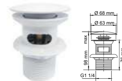
A153 Донный клапан Push-up для раковины с переливом. покрытие белый Soft-touch.
