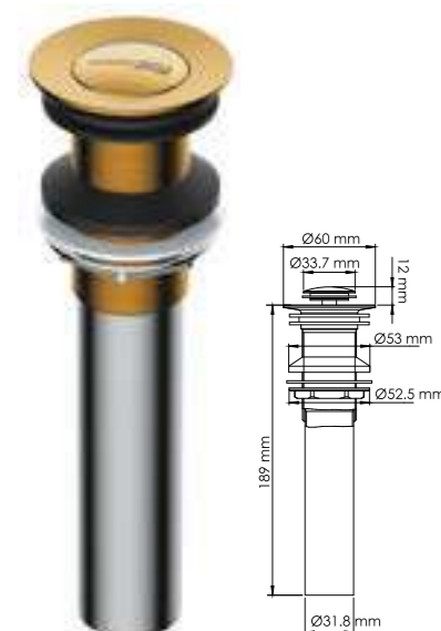
A252 Донный клапан Push-up для раковины без перелива. PVD-покрытие «матовое золото».
