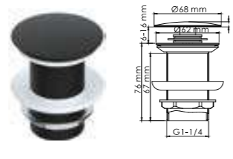
A245 Донный клапан Push-up для раковин с переливом Покрытие черный Soft-touch.
