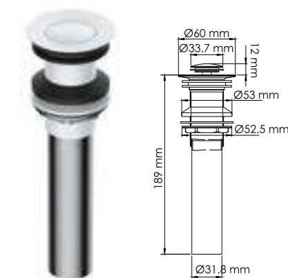
A251 Донный клапан Push-up для раковины без перелива покрытие белый Soft-touch.
