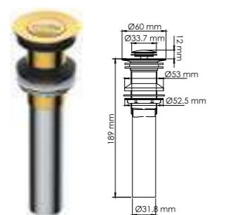
A253 Донный клапан Push-up для раковин с переливом PVD-покрытие «глянцевое золото».
